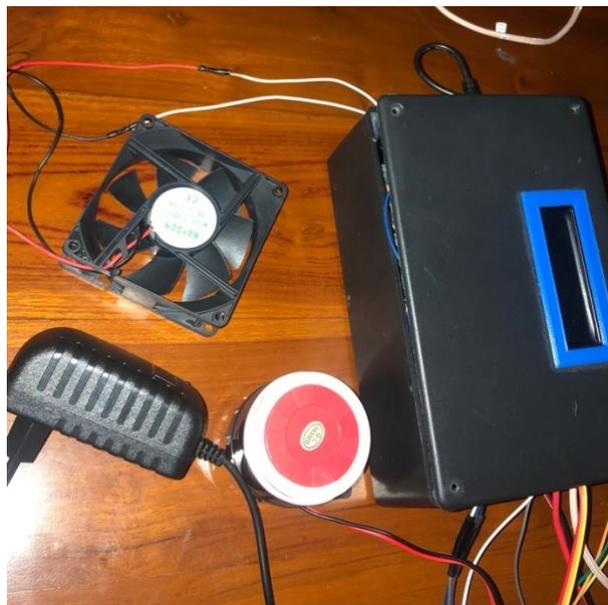
Gambar 5. 6 Actuator Kipas dan Buzzer
