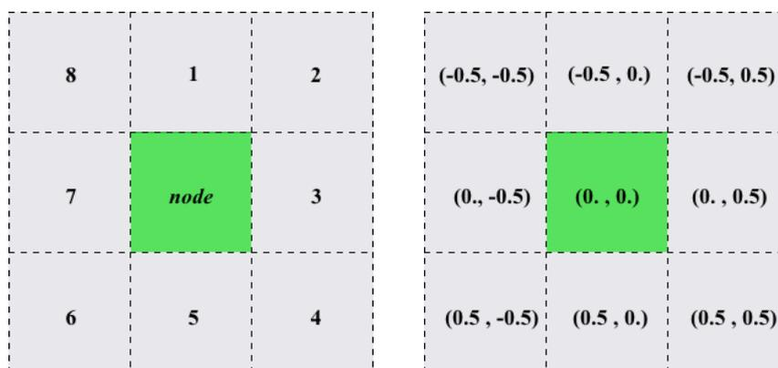
Langkah selanjutnya adalah menentukan jarak aman terhadap *obstacle* atau robot lawan, dan robot kawan untuk menghindari tabrakan saat pencarian rute menggunakan algoritma A\*. Jarak aman terhadap tabrakan bisa berubah sesuai dengan kebutuhan yang ingin diterapkan pada robot. Tabel dibawah ini merepresentasikan jarak aman terhadap tabrakan robot.
