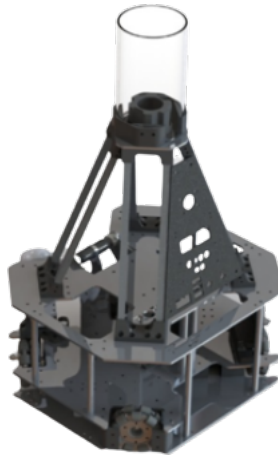
Gambar 2.1 Desain mekanik robot sepak bola beroda
