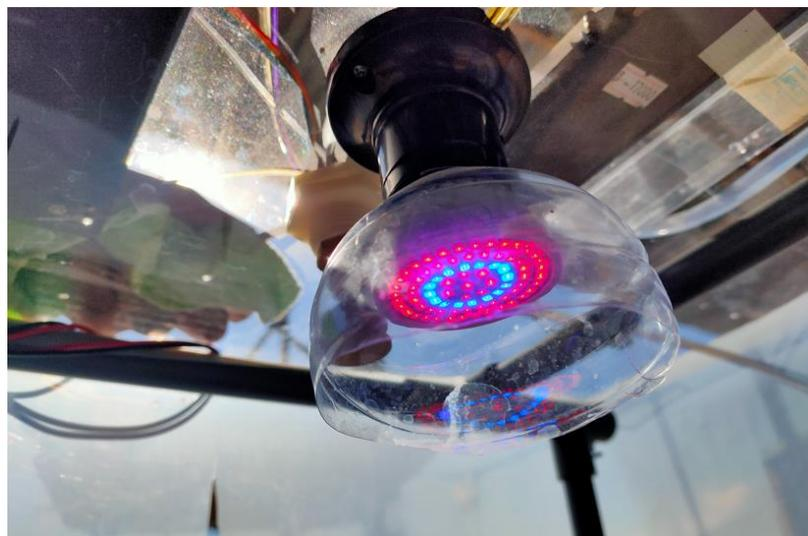
Gambar 6.1.6 Aktuator Lampu Kondisi Dingin, Basah, dan Gelap
