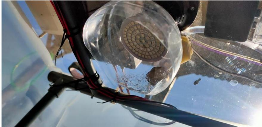
Gambar 6.1.9 Kondisi aktuator lampu pada kondisi dingin, basah, dan terang
