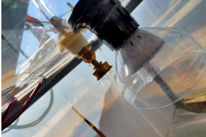
Gambar 6.1.13 Kondisi aktuator pompa pada kondisi dingin, basah, dan gelap
